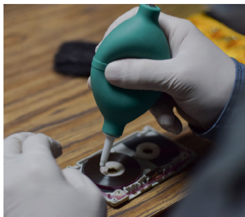
Fotografía 3. Proceso de eliminación de partículas magnéticas desprendidas de la cinta magnética con perilla de aire. Se utilizan guantes para evitar el contacto directo con el material.
